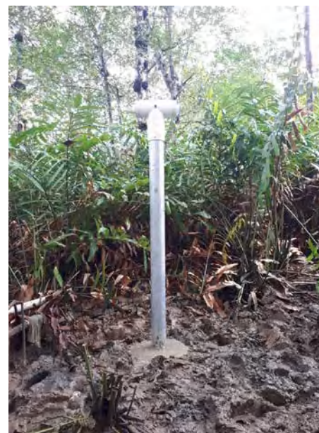
FIGURA 5: Fotografía de un piezómetro instalado y esquema constructivo del mismo.
