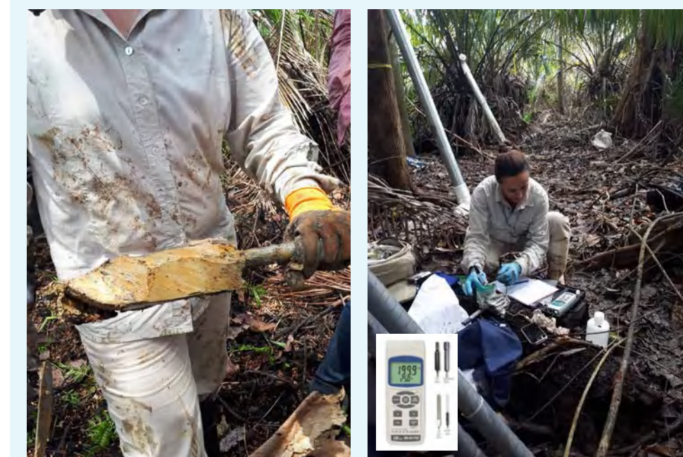
FIGURA 4: Muestreo de sedimentos durante la realización de las perforaciones y medición de parámetros en campo con sonda multiparamétrica.
