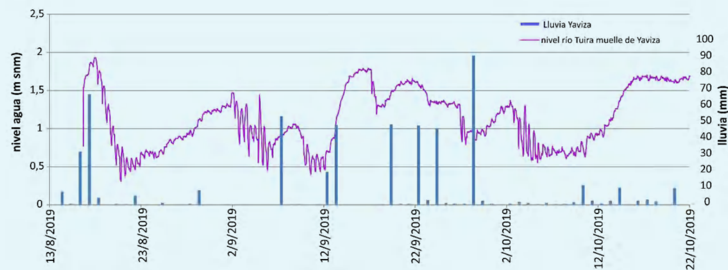
FIGURA 15: Comparación de datos de precipitación y niveles de agua en el río Tuira registrados en Yaviza.
